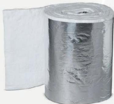
Materassino Fibra di Vetro ad alta temperatura di colore bianco, costituito da fibrelunghe di superwool o similari agugliate meccanicamente, rivestito su un lato con alluminio retinato. Impiegabile ad una temperatura limite di classificazione di 1200 °C. Indicato per canne fumarie di apparati funzionanti con combustibile solido (legno, pellet, etc)
